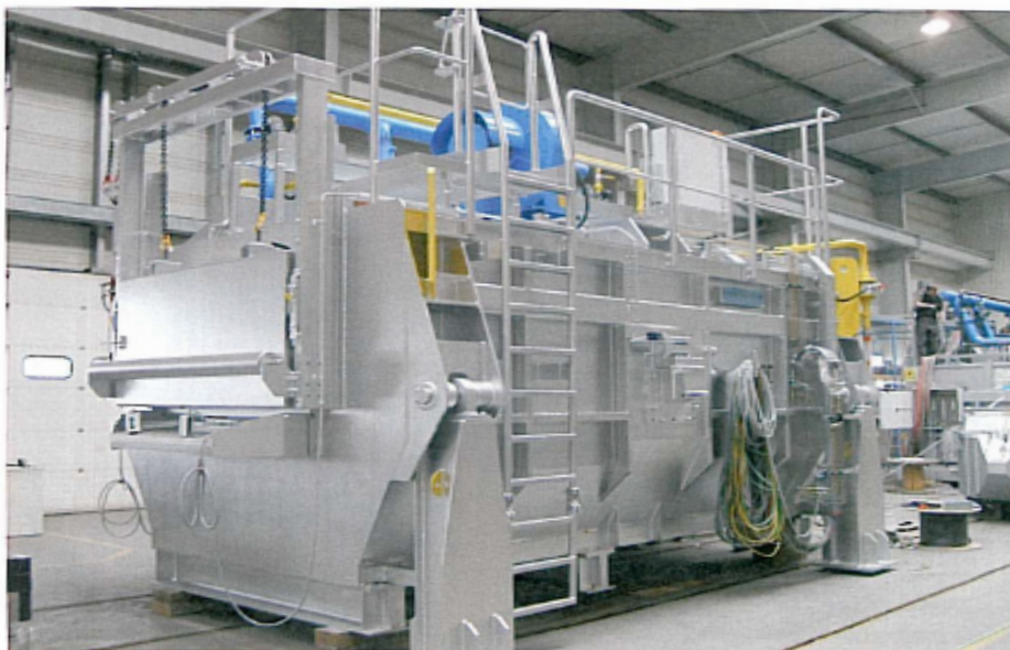
Ein neuer StrikoWestofen HR - T 10.000/500 mit Rampe, geregelt hydraulisch kippbar
